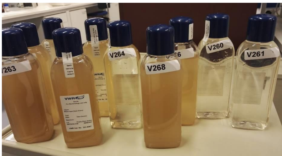
Kuva 16. Vedenlaatu vaihtelee vesistön eri kohdissa, pullojen näytteet otettu voimakkaiden sateiden jälkeen 17.2.2020 (kuva: Tiina Asp, Länsi-Uudenmaan vesi ja ympäristö ry).
