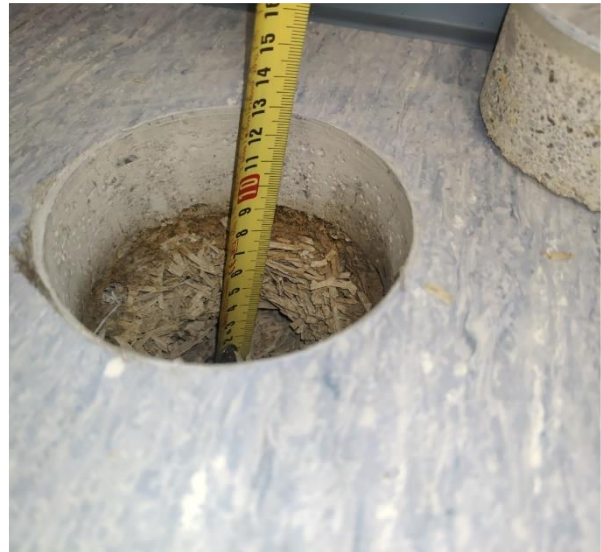
Kuva 58 Lastusementtilevyssä todettiin vahva viite mikrobikasvustosta näytteessä.
